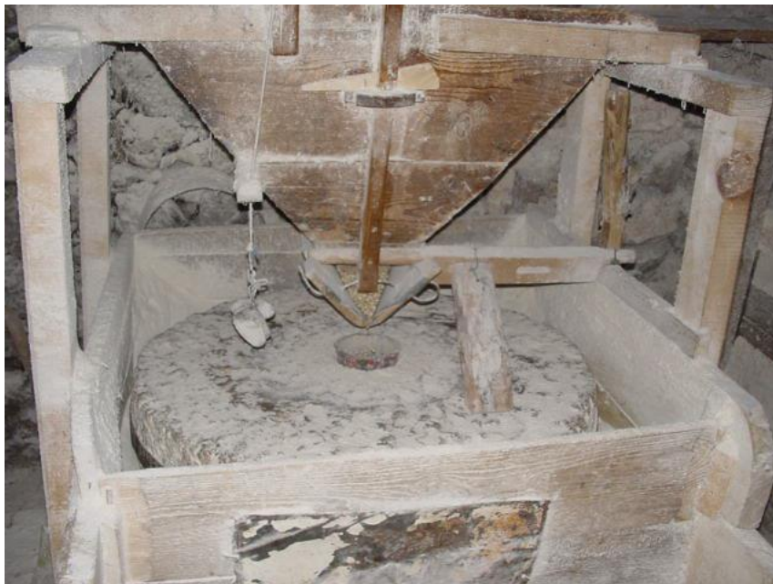
Slika 11 Sistem mljevenja, Qëlë Bic mlin, Vrelle - star 4 generacije.
